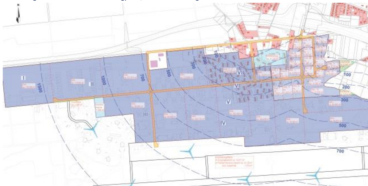
Abbildung 18: Niederkrüchten – Flugplatz, Abstandslinien gemäß Abstandserlass NRW
